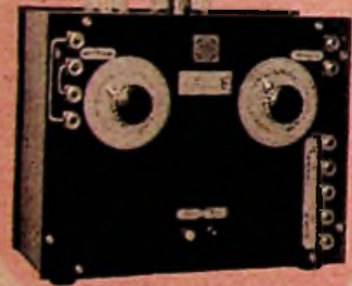
Telefunken H, das Empfangsgerät aus den Kindertagen des deutschen Rundfunks
