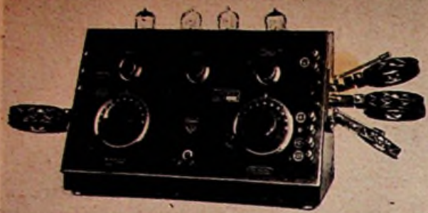
Vierröhren-Empfänger Rfe 9b mit angebauten Steckspulen
